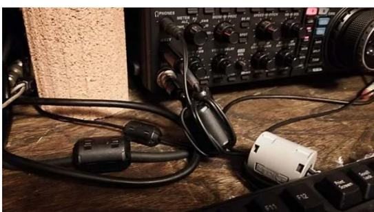
あとは、トロイダルコア(パッチインコア)を大小相当数購入し、電源回りやケーブル周りに挿入した。コモンモード電流が外に出ていかないように抑制しようとした。
