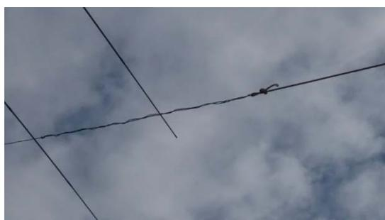
い。」という判断で、3.5メガのワイヤーを折り返して、3.5メガに同調させることを考えた。計算してみると、1メートル52センチほど、折り返すといい。ただ、折り返すことで、本当に電氣的長さがぴったりと短くなるのか、疑問もあった。一応私のSWR計で測ったところ、まずまずのSWRに収まっていた。もう少し検討を加えるため、いつもお世話になっているローカル局にアンテナアナライザーをお借りして、ちょうど、3.8メガになるように長さを調整した。最初に調整した長さより20センチ
